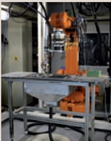
Sistema robotizado de soldadura híbrida láser-arco.
